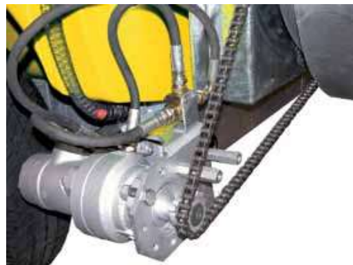
Регулировка с помощью гидравлического двигателя и зубчатого редуктора
