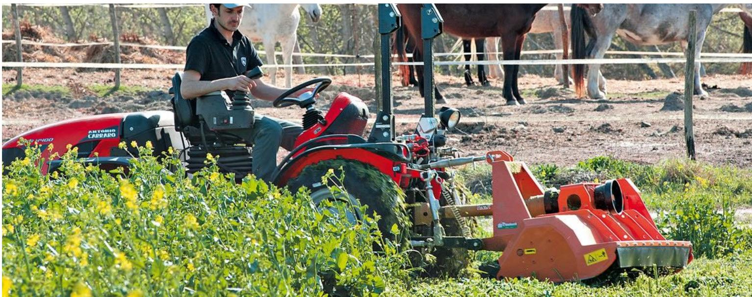
Некоторые модели выполнены в узком корпусе, что позволяет проводить работу между узкими рядами виноградной лозы.
